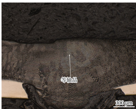
图 12 FDPM-LW 焊缝截面金相组织
